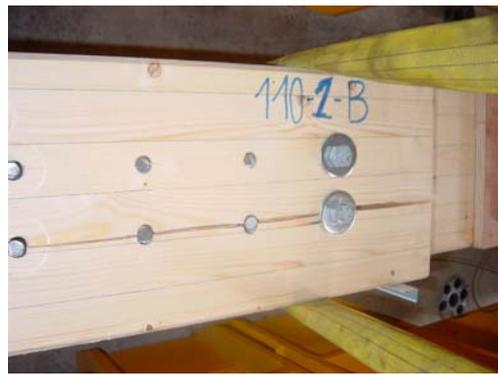
Rupture par cisaillement de file
