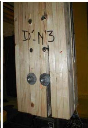
Rupture par cisaillement de file
