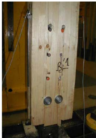
Rupture de bloc
