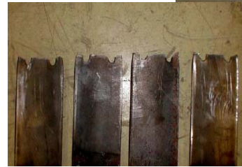
Rupture des plaques
