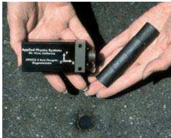
FIG. 1.10 – Balise magnétique utilisée dans le programme PATH
