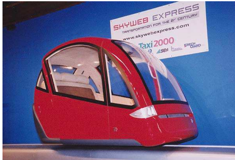
FIG. 1.7 – Navette du SkyWeb Express Personal Rapid Transit
