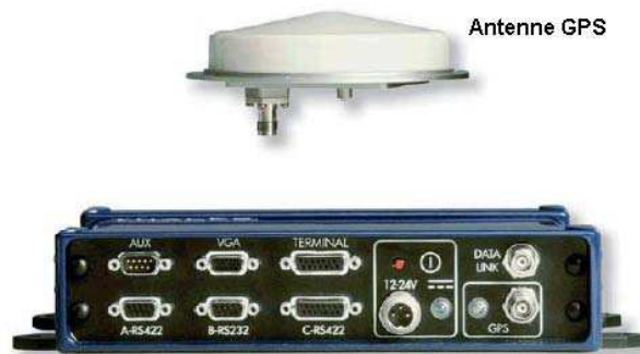
FIG. 4.4 – Le Sagitta : un capteur RTK-GPS
