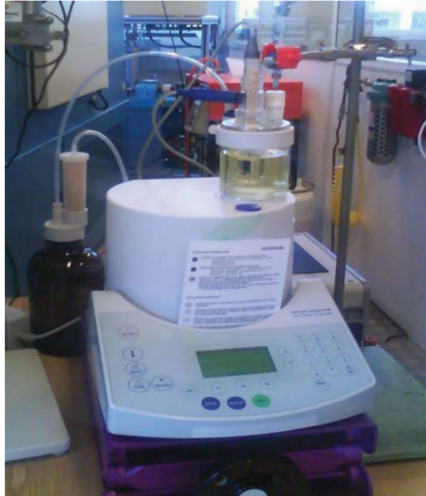
Figure 5-5 : Vue d'ensemble du coulomètre Karl Fischer
