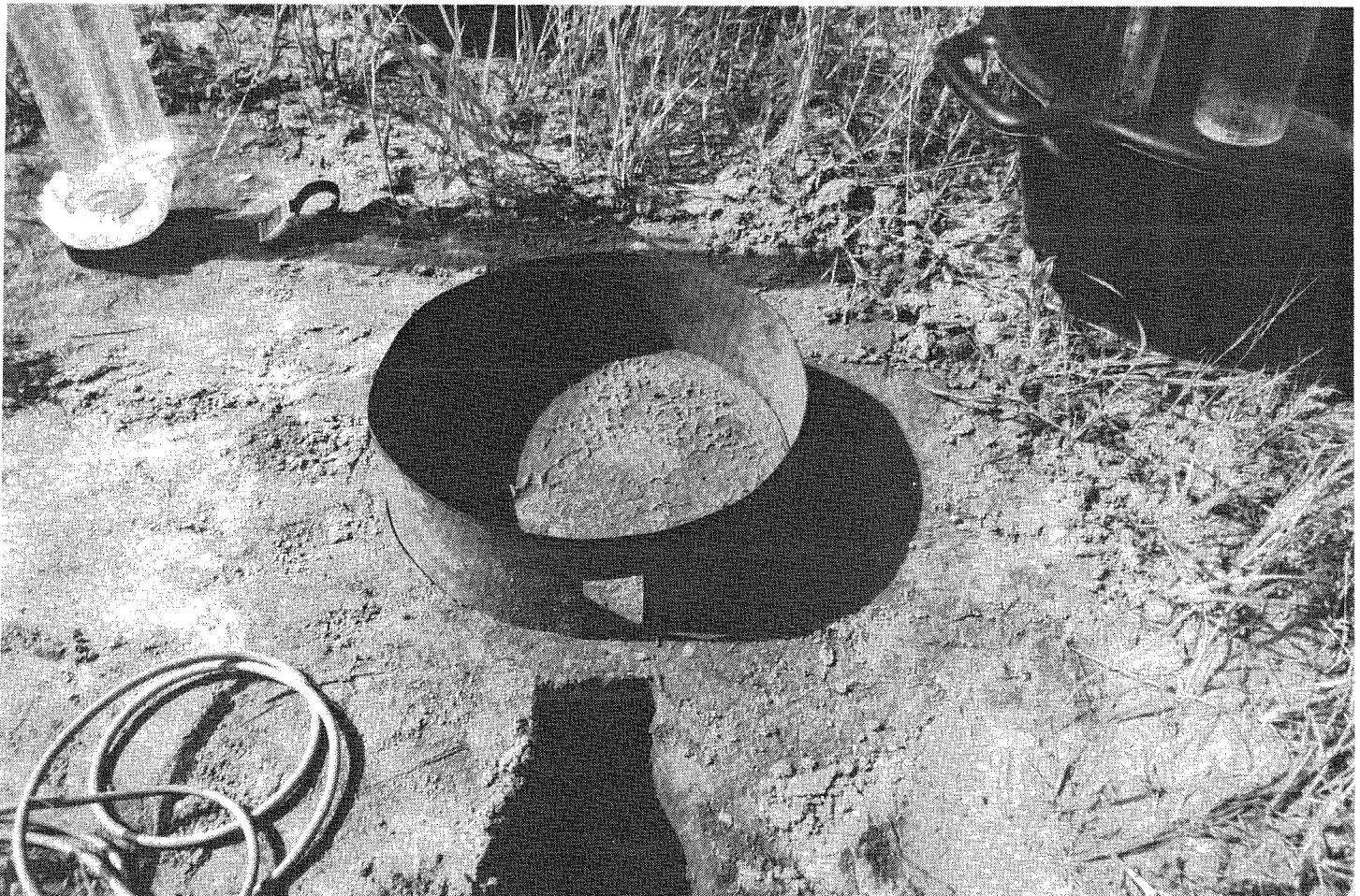
Figure 9.23. Essai pseudo-monodimensionnel : cylindre et fosse tensiométrique.
