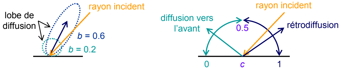
Fig. 2.7 : Représentation des paramètres de phase b (paramètre d'asymétrie) et c (fraction de rétrodiffusion).
