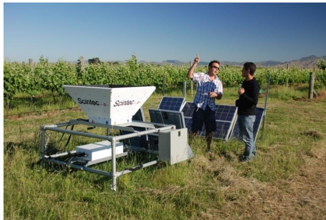
Photographie 2 : Utilisation d'un Sodar pour analyser la stratification verticale de l'atmosphère : exemple des vignobles de la région de Marlborough (Nouvelle-Zélande).
