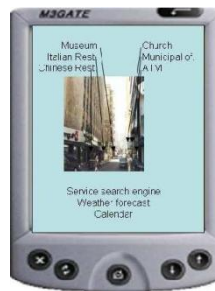
Figure F5 - Utilisation d'une représentation de type Google Street-View Laquelle peut présenter un problème de superposition des noms en 3D.
