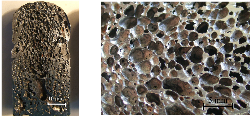
Figure III-8 - Mousse de fonte : vue générale (à gauche) et zoom sur la structure (à droite).
