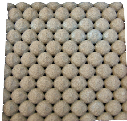
Figure IV-14 - Plaque en sable réalisée au moyen de la boîte à noyaux présentée en Figure IV-13.
