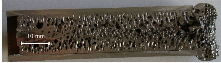
Figure III-9 - Mousse de fonte solidifiée dans un tube en acier.
