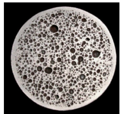
Figure I-33 - Mousse d'acier développée par l'IFAM, introduite dans un tube en acier (50% de porosités) [KRE2004].
