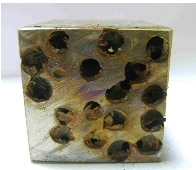
Figure IV-5 - Epreuve 1Bis après dissolution du sel.
