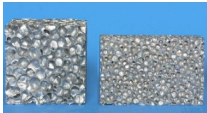
Figure I-20 - Échantillons de mousse Metcomb ® avec des tailles de pores différentes [LEI2002].
