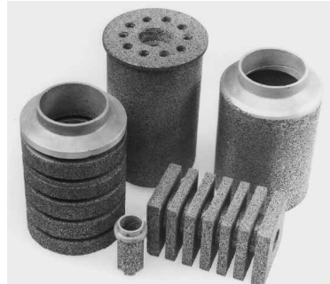
Figure I-47 - Pièces alvéolaires de l'IFAM [BAN2001a].
