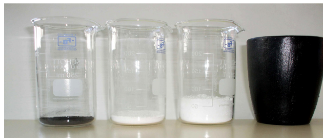
Figure III-6 – De gauche à droite : 20 g de \text{ZrH}_2 , 18 g de \text{MgCO}_3 , 31,6 g de \text{SrCO}_3 et creuset pouvant contenir environ 500 g d'acier (ou de fonte) liquide.
