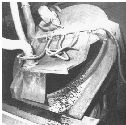
Figure I-45 - Machine de bouletage utilisée pour fabriquer des billes [GRO1999].
