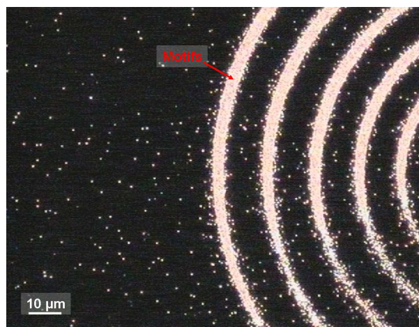
Figure 2.11 : Image optique d'un motif en diamant réalisé par lift-off , après une croissance des cristaux de diamant de 30 minutes
