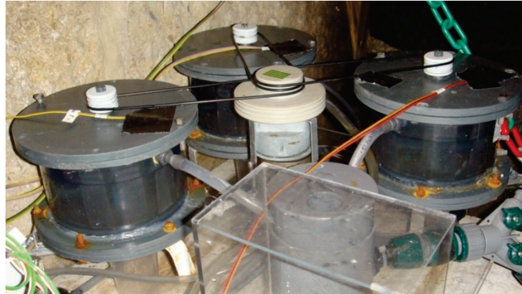
Figure 21: Banc de réacteurs composé de 3 incubateurs (chacun d'eux représentant un réplicat).
