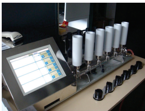
Figure 23 : GeneExtract équipé des cylindres de filtration.
