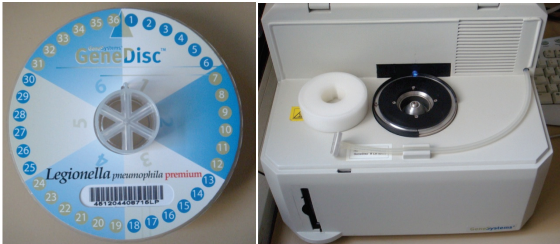
Figure 24: GeneDisc vu de dessus (à gauche) et GeneDisc cyclier (à droite).
