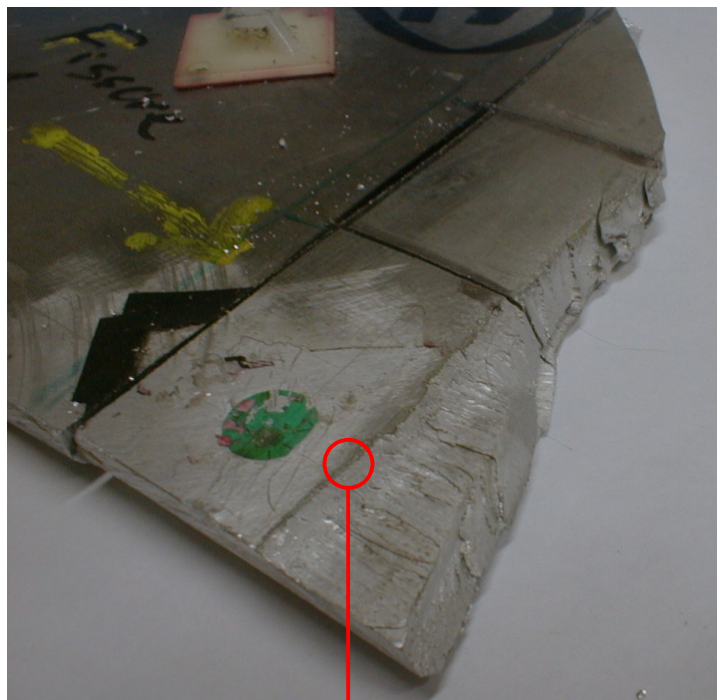
Figure 305 : vue globale de la fissure de la soudure II côté gauche
