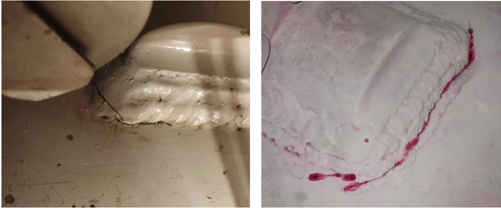
Figure 350 : amorçage de la fissure (à gauche) et propagation de la fissure (à droite)
