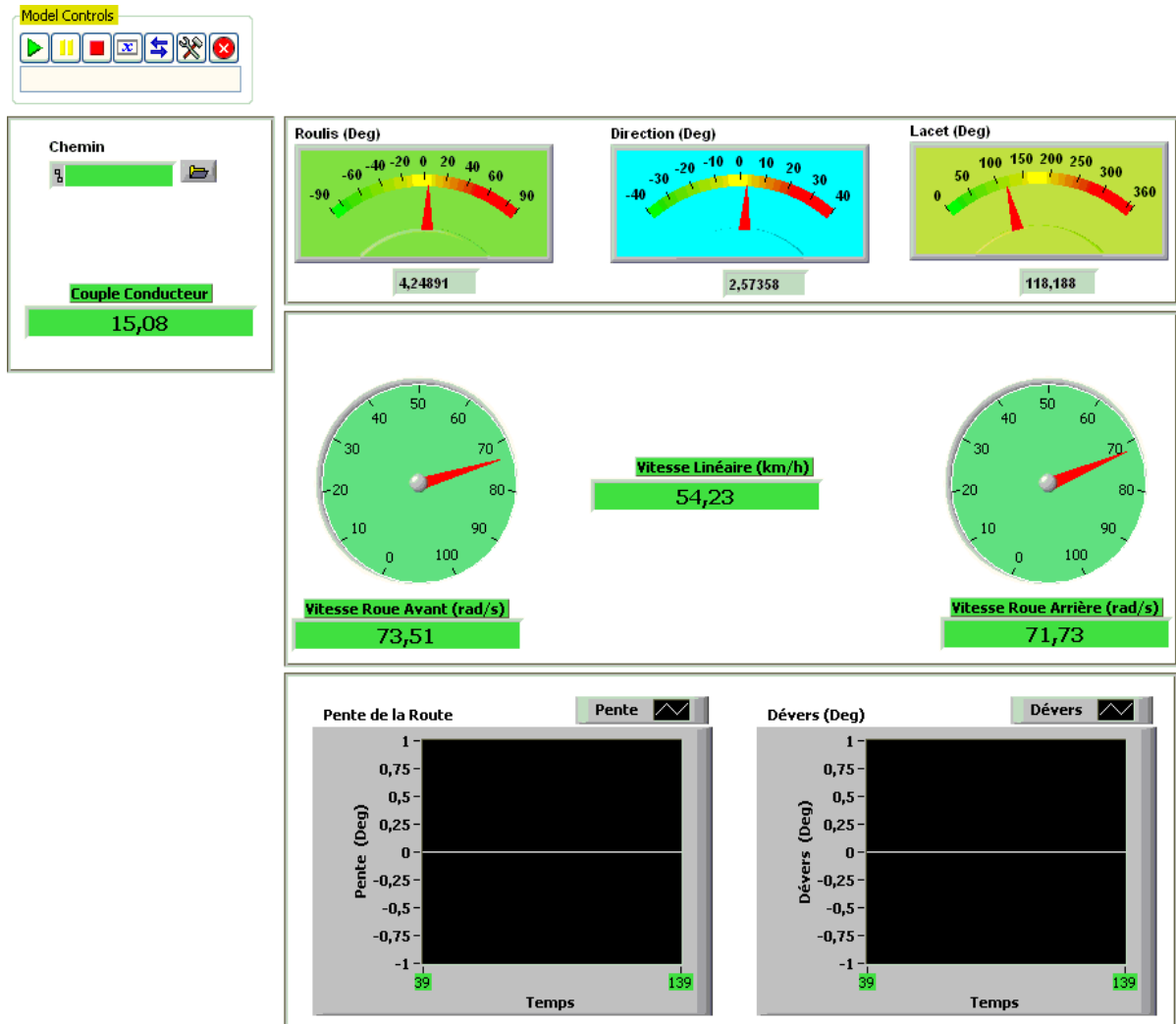
FIGURE 2.28 – Interface LabVIEW pour la simulation des véhicules à deux roues
