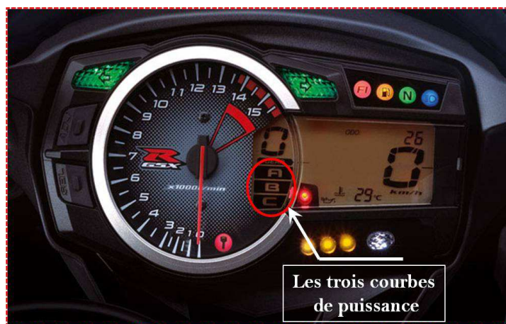
FIGURE 1.7 – Tableau de bord à cartographie réglable sur la Suzuki GSX-R 1000
