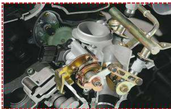
FIGURE 1.8 – Accélérateur Drive-by-Wire sur la Yamaha
