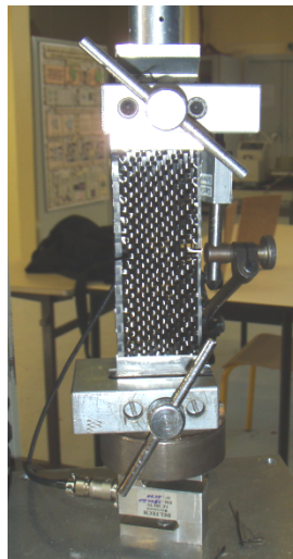
Figure 3.15 : Dispositifs des essais de traction unidirectionnelle
