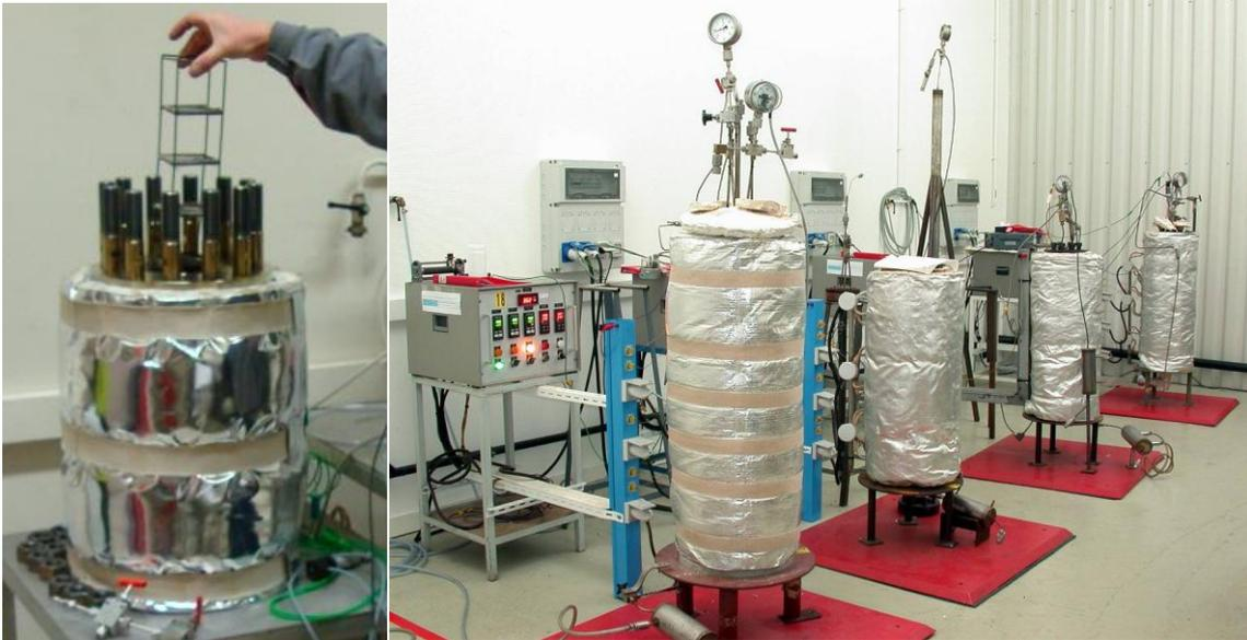
**Figure II.2: Introduction d'échantillons dans un autoclave statique**
