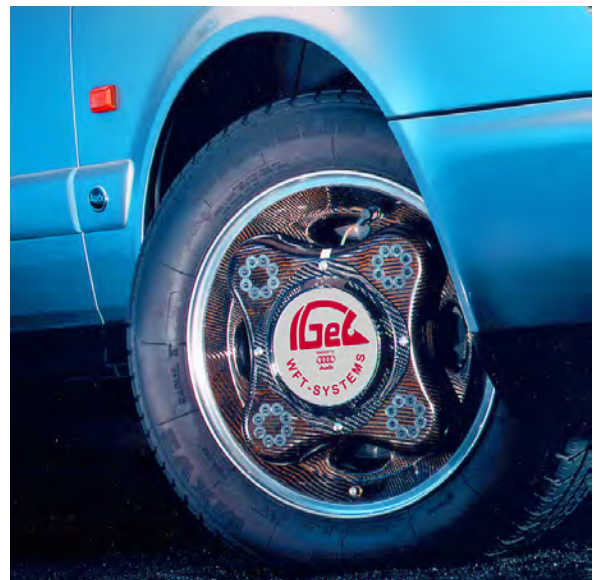
Figure 3-75: Roue dynamométrique sur un véhicule
