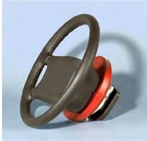
Figure 3-72 : Le volant dynamométrique
