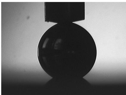
Fig. II.30: Mesure de l'angle de contact d'équilibre Galinstan/silice.
