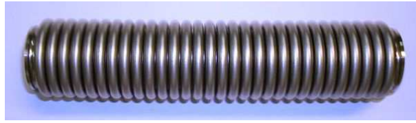
Fig. III.6: Soufflet métallique ( L = 126 mm).
