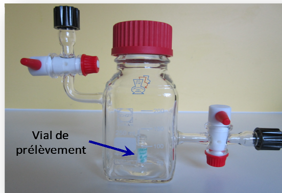
Figure III-2 : Chambre contenant un vial de prélèvement
