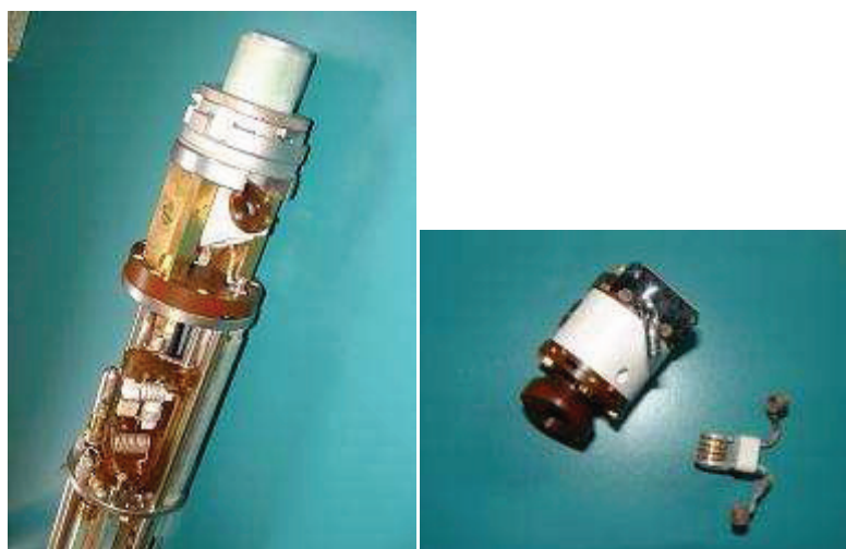
Figure 3.3 17 : Tête de sonde MAS (à gauche) - Bobine de radiofréquence et stator MAS (à droite) (d'après IRCELYON)
