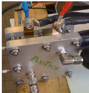
Figure 7 : Cellule Paxitech<sup>®</sup> de 25 cm<sup>2</sup>.
