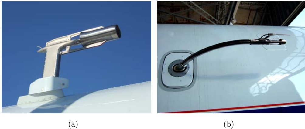
FIGURE 3.3 – Photos des veines de prélèvement CVI (a) et CAI (b) utilisées respectivement pour les campagnes POLARCAT de printemps et d'été (photos par A. Matsuki)
