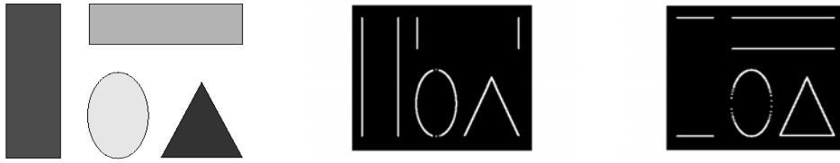
FIG. 2.22 – Exemple de gradients d’une image. A gauche : image initiale, au centre : gradients horizontaux, à droite : gradients verticaux.
