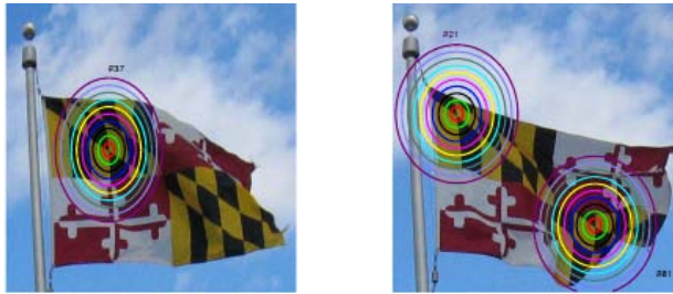
FIG. 2.35 – Exemple d'un descripteur de Cheng, analysant suivant s régions d'intérêt proportionnelles à l'échelle locale. (images extraites de [22])
