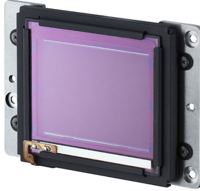
FIGURE 2.7 : Illustration d'un capteur CCD Kodak : il contient 40 millions de pixels pour une taille de 40x33 mm (soit 6x6 \mu\text{m} par pixel).
