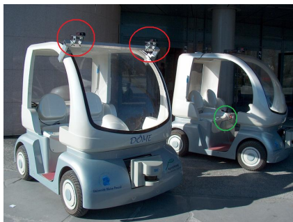
FIGURE 2.23 : Position des caméras (cercles rouges) et du GPS (cercle vert).
