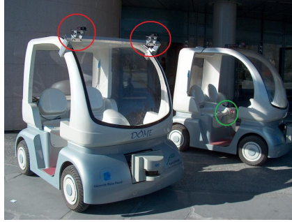
FIGURE 4.2 : Position des caméras (cercles rouges) et du GPS (cercle vert).
