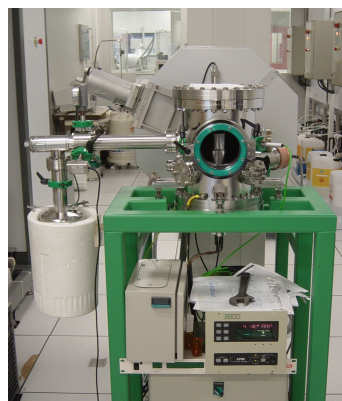
FIGURE 4.31 – Four de recuit sous vide utilisé.
