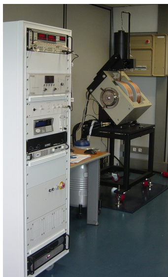
FIGURE 2.13 – Magnétomètre à échantillon vibrant utilisé.
