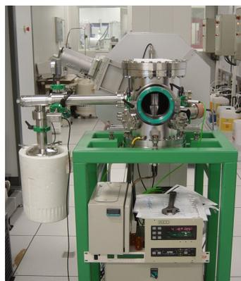
FIGURE 4.31 – Four de recuit sous vide utilisé.
