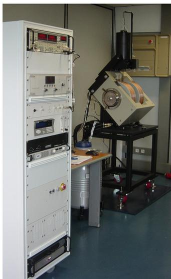
FIGURE 2.13 – Magnétomètre à échantillon vibrant utilisé.
