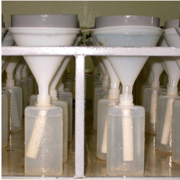
Photo 8 et 9 : Vues des dispositifs utilisés pour l'extraction des nématodes par aspersion
