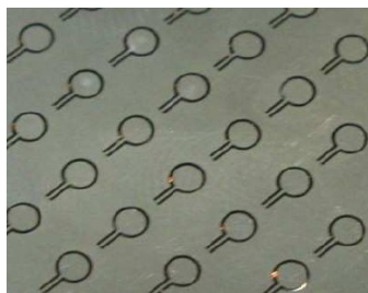
Figure 2.4 – Actionneurs non équipés de picots, constituant le Vitale (CEA [34])
