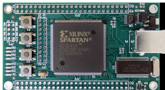
Figure 3.34 – Carte FPGA XEM3001 destinée à la génération des signaux de commande
