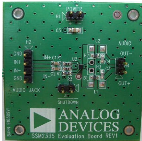
Figure 3.33 – Carte d’évaluation de l’amplificateur audio SSM2335 d’Analog Devices
