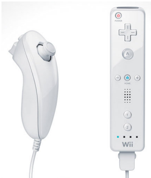
Figure 1.3 – La manette de la console de jeu Nintendo Wii [9], équipée d'un retour vibrant
