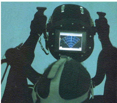
Figure 1.7 – Le QinetiQ Diver Reconnaissance System testé par un plongeur de la Royal Navy [13]
