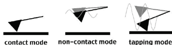
FIGURE 2.6 – Schéma des modes d'imagerie en contact, non contact et tapping de l'AFM [66]
