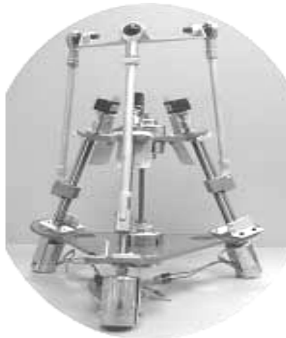
Figure 1-7 : Mécanisme de la machine outil « Parawrist » [Ryerson]
