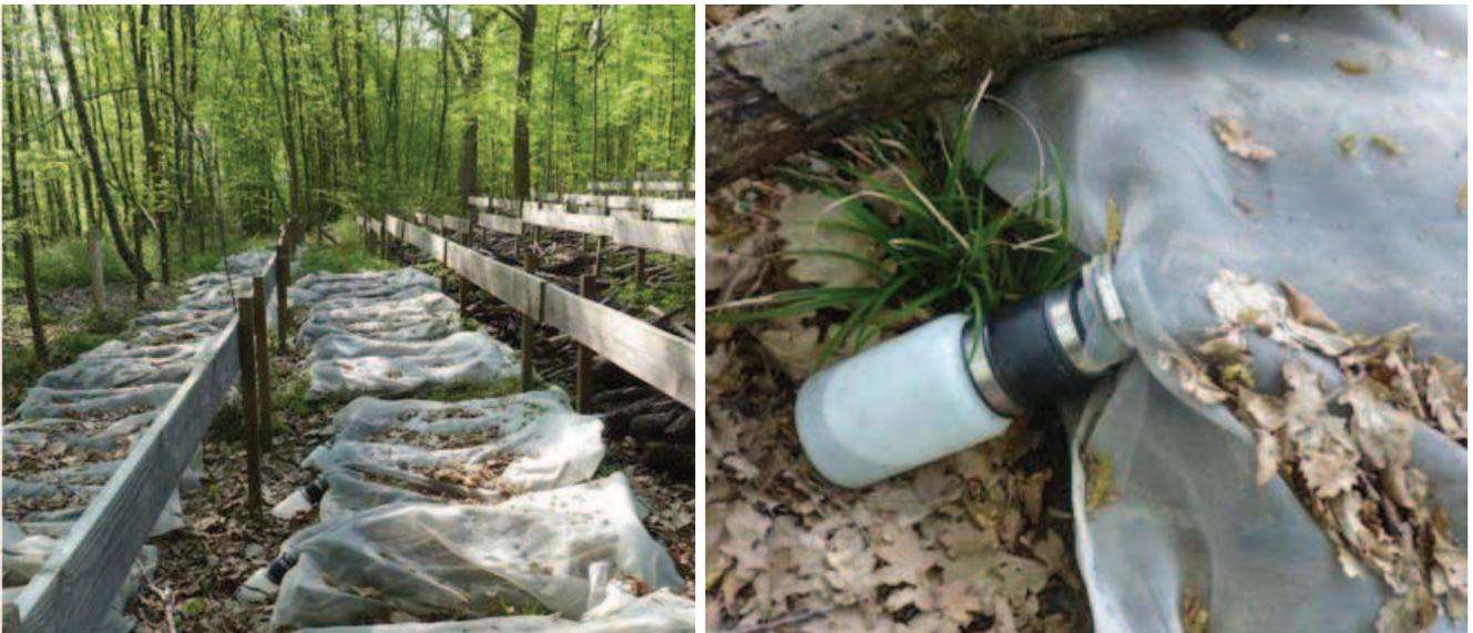
Dans chacune des nasses il a été placé des rémanents de coupe, d'une longueur de 1 m, correspondant au plan d'échantillonnage. Afin d'obtenir des volumes comparables, il a été placé dans chaque nasse 30 pièces de bois pour les petits diamètres (classe 5) (volume  $\approx 0.06 \text{ m}^3$ , surface  $\approx 4.71 \text{ m}^2$ ) et 10 pour le diamètre supérieur soit la classe 10 (volume  $\approx 0.08 \text{ m}^3$ , surface  $\approx 3.14 \text{ m}^2$ ).
