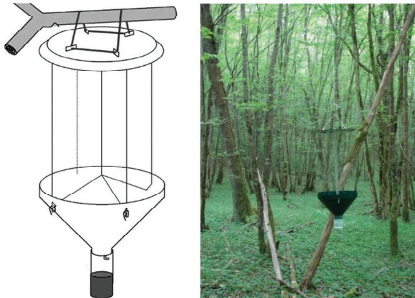
**Figure 6 :** Schéma d'un piège vitre (Polytrap)
