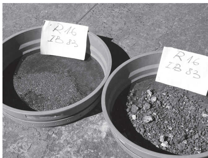
Figure 16 : Séchage des refus de tamis après tamisage à l'eau.
