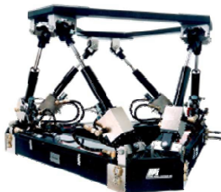
Figure 1-2 : Mécanisme pleinement parallèle de type hexapode
