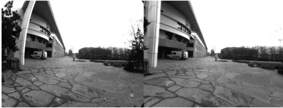
FIG. 3.3 – Une image prise avec un objectif fish-eye à gauche et l'image après correction de la distorsion à droite.
