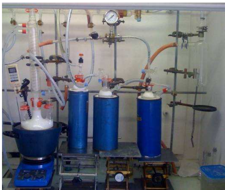
Figure II-26. Photo du montage réalisé pour la synthèse du borazine.
