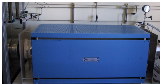
Premier four de traitement thermique pouvant fonctionner sous ammoniac et azote.
