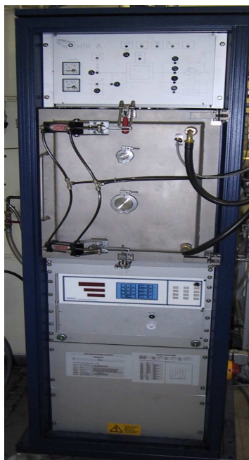
Second four de traitement thermique fonctionnant exclusivement sous azote ou argon.
