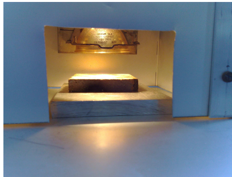
Photo de la boîte contenant la lampe halogène .
