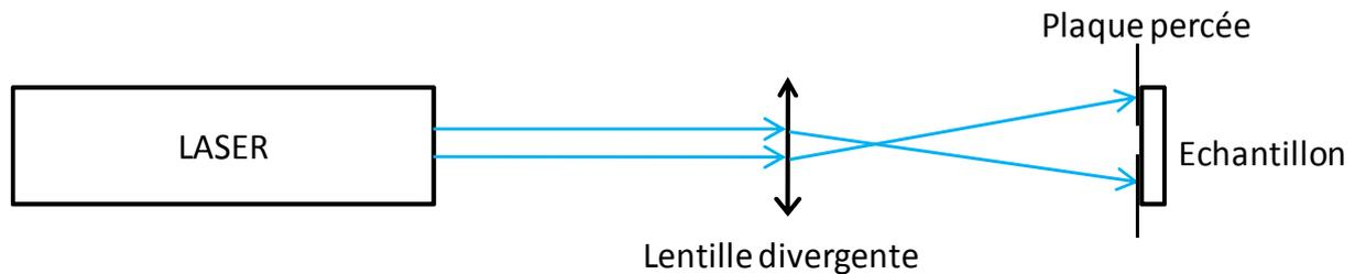
*Figure 60* Schéma du montage de la photoréduction du sel d'argent.
