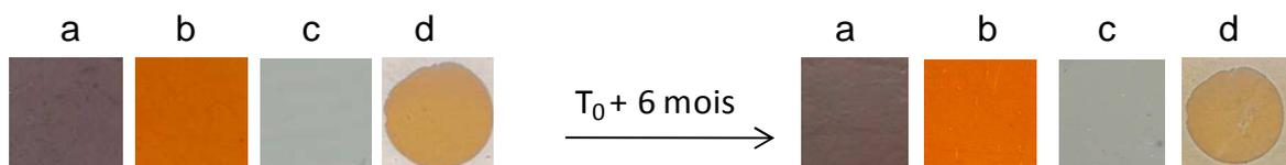
Figure 94 Stabilité des échantillons : (a)  $TiO_2\text{-an@Ag-C0,05M}$ , (b)  $TiO_2\text{-an@Ag-C0,15M}$ ,  $TiO_2\text{-an@Ag-T300}^\circ\text{C}$ ,  $TiO_2\text{-an@Ag-O5min}$  après 6 mois.
