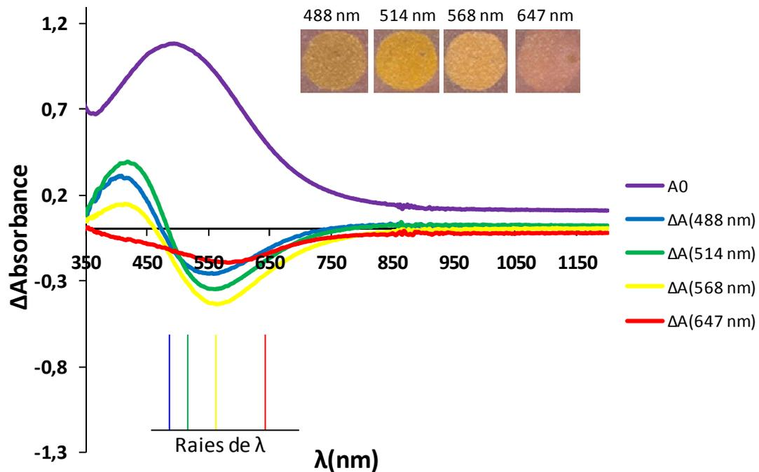
**Figure 106** Evolution de la différence d'absorbance de l'échantillon TiO<sub>2</sub>-am@Ag-C0,05M avant (A0) et après insolation pendant 90 min à différentes longueurs d'onde avec une faible puissance du laser (0,226 W/cm<sup>2</sup>) et couleurs de l'échantillon.
