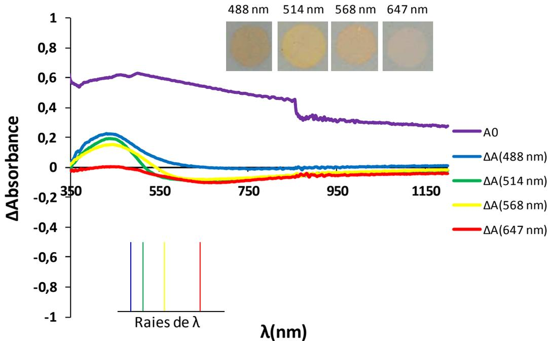
**Figure 120** Evolution de la différence d'absorbance de l'échantillon TiO<sub>2</sub>-an@Ag-T300°C avant (A0) et après insolation pendant 90 min à différentes longueurs d'onde avec une faible puissance du laser (0,226 W/cm<sup>2</sup>) et couleurs de l'échantillon.
