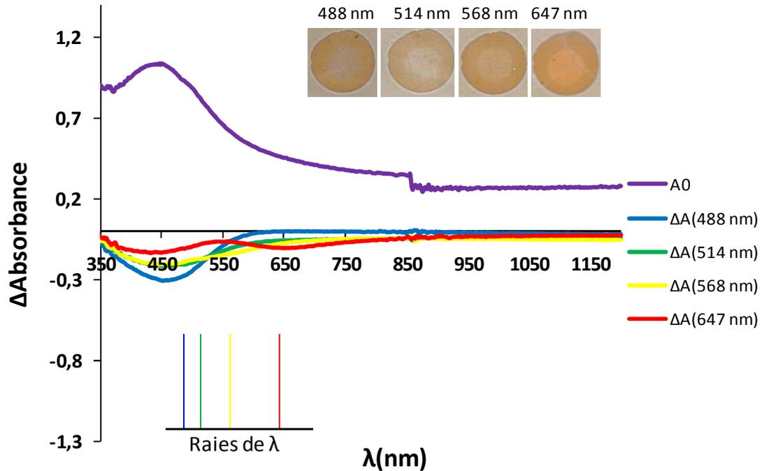
**Figure 114** Evolution de la différence d'absorbance de l'échantillon TiO<sub>2</sub>-an@Ag-O5min avant (A0) et après insolation pendant 90 min à différentes longueurs d'onde avec une faible puissance du laser (0,226 W/cm<sup>2</sup>) et couleurs de l'échantillon.
