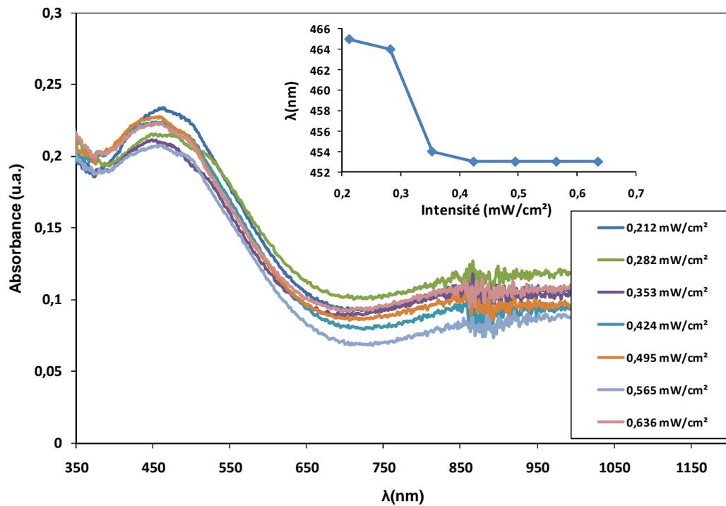
**Figure 63** Spectres UV- visible des échantillons SBA-15/Ag réduits optiquement avec une intensité lumineuse variant de 0,282 à 0,353 mW/cm<sup>2</sup>. Variation de la longueur d'onde à la résonance avec l'intensité lumineuse.
