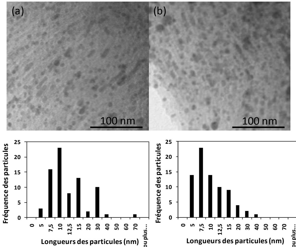
Figure 64 Images MET des échantillons SBA-15/Ag réduits optiquement avec une intensité lumineuse de (a) 0,282 et (b) 0,353 mW/cm<sup>2</sup>.
