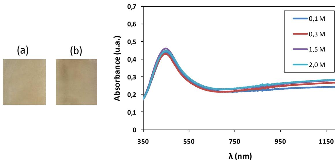
**Figure 58** Photographies des échantillons imprégnés dans une solution de sel d'argent de concentrations (a) 0,3M ou (b) 2M (Gauche), Evolution des spectres des films contenant des nanoparticules d'argent en fonction de la concentration de la solution précurseur (Droite).
