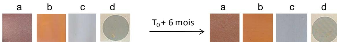
**Figure 82** Stabilité des échantillons : (a) TiO<sub>2</sub>-am@Ag-C0,05M, (b) TiO<sub>2</sub>-am@Ag-C0,15M, TiO<sub>2</sub>-am@Ag-T300°C, TiO<sub>2</sub>-am@Ag-O5min après 6 mois.
