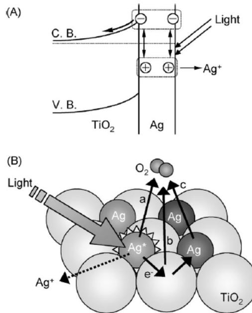
**Figure 22** (A) mécanisme proposé pour la séparation de charge à l'interface entre une nanoparticule d'argent et le  $\text{TiO}_2$ ; (B) cheminement possible des électrons de nanoparticules d'argent excitées vers une molécule d' $\text{O}_2$  [201].
