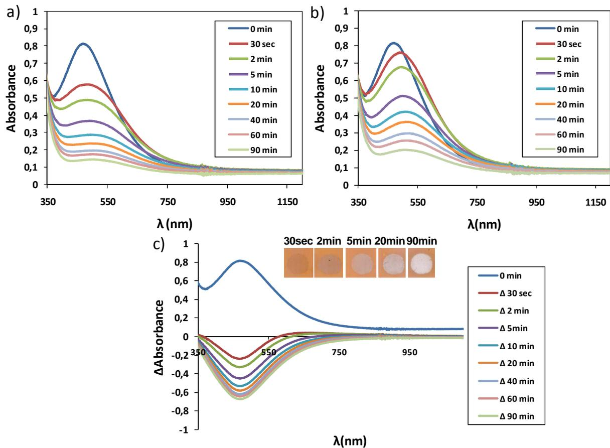
**Figure 102** Spectres d'absorbance de l'échantillon TiO<sub>2</sub>-am@Ag- C0,15M enregistrés sous incidence normale et lumière polarisée parallèlement (a) ou perpendiculairement (b) à la polarisation du laser  $E_L$  avant et après insolation à 488 nm pendant différents temps ( $I = 3,25 \text{ W/cm}^2$ ). c) Evolution de la différence d'absorbance avec le temps d'insolation et couleurs correspondantes de l'échantillon.
