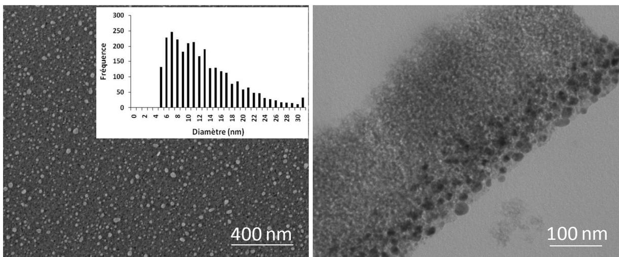
**Figure 81** Images MEB (gauche) et MET (droite) de l'échantillon TiO<sub>2</sub>-am@Ag-O5min.
