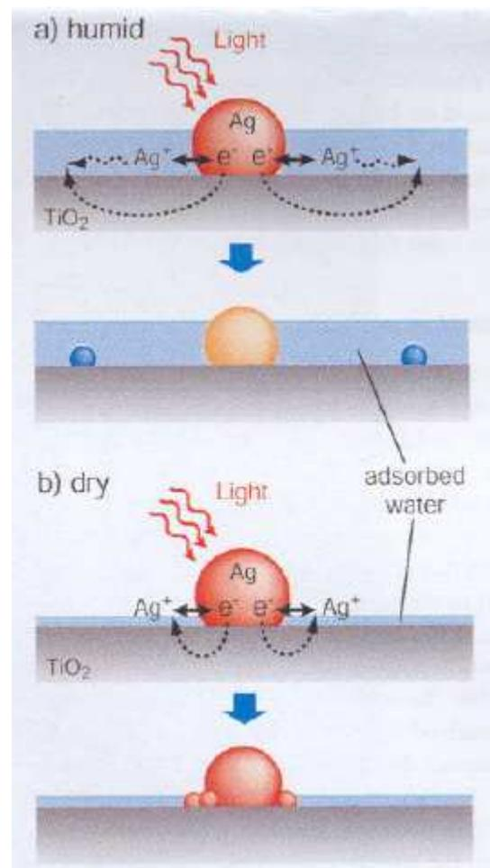
**Figure 29** Schéma illustrant la dissolution photo-électro-chimique et le re-dépôt des NP d'Ag sur des matériaux  $\text{Ag}/\text{TiO}_2$  à basse densité sous conditions sèches et humides [203].
