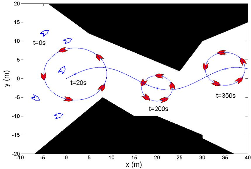
FIGURE B.7 – Simulation de cinq agents régis par la loi de commande (B.14) avec  $\mathbf{G}(t) = \mathbf{T}_{c(t)}\mathbf{S}_{R(t)}$ . La formation circulaire, dont le centre suit une référence variant dans le temps, change de rayon, afin d'éviter les obstacles (blocs noirs).
