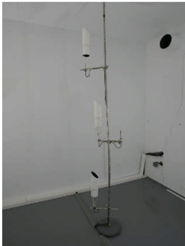
Figure 2.5 – Mat équipé de capteurs de température
