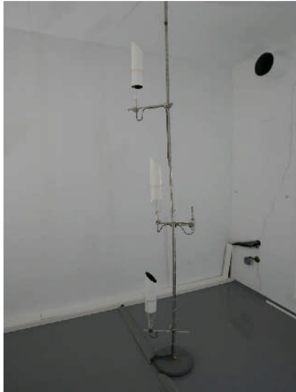
Figure 2.5 – Mat équipé de capteurs de température
