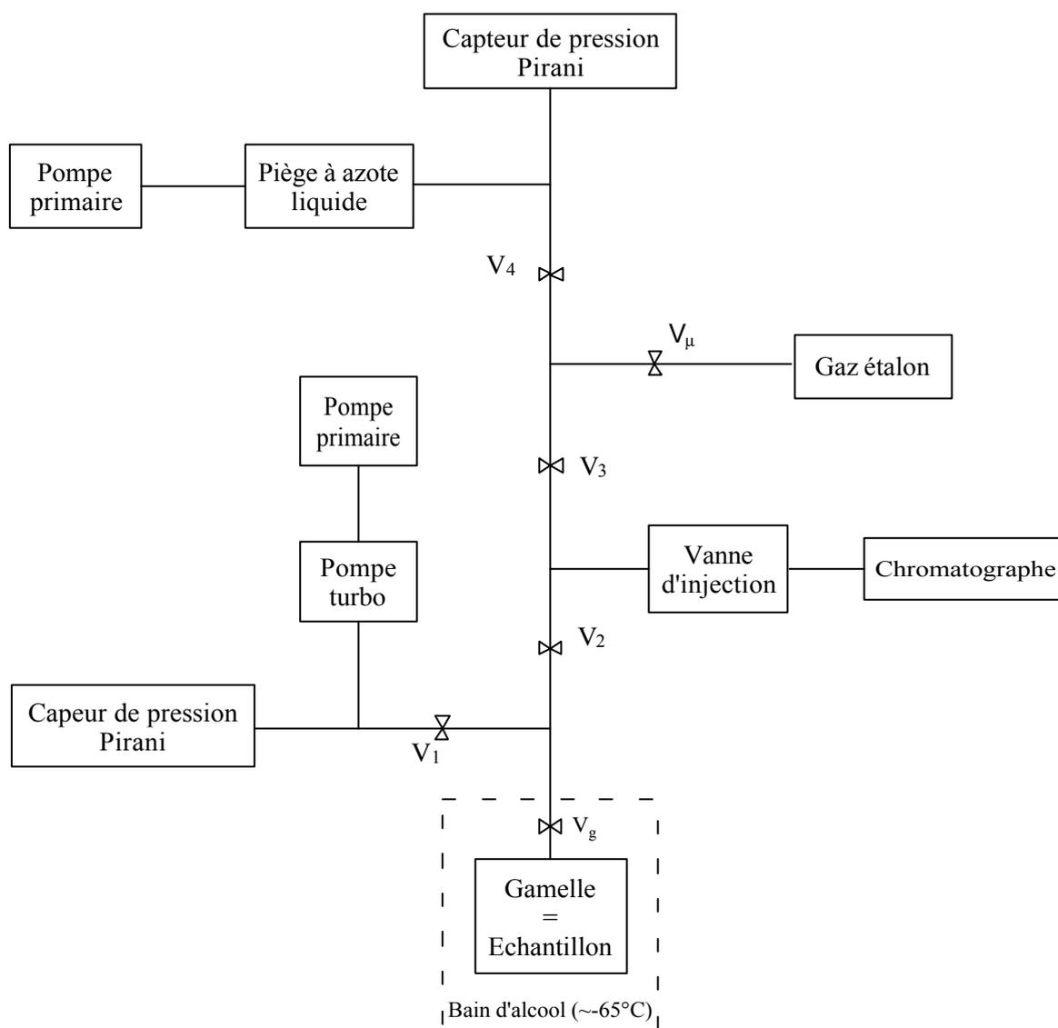
*Figure II- 3 : Schéma de la ligne d'extraction.*
