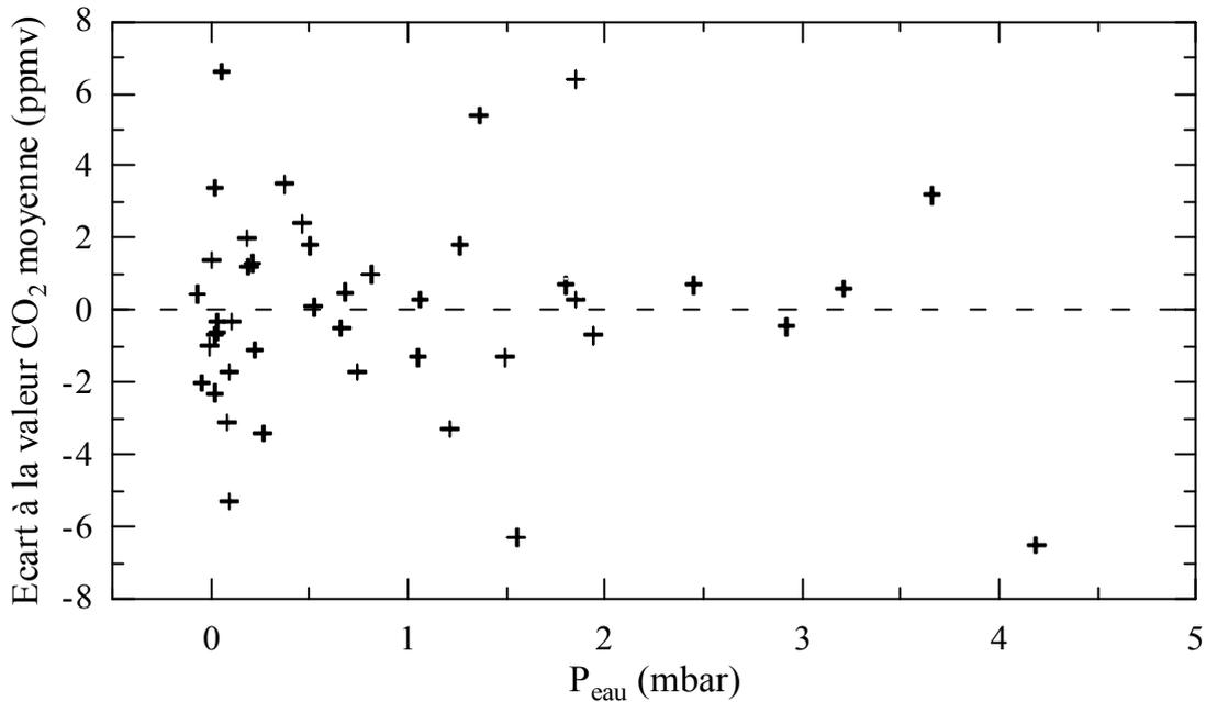
*Figure II- 5 : Déviation de la teneur en CO<sub>2</sub> d'un échantillon par rapport à la moyenne sur un niveau, en fonction de la quantité d'eau présente (moyenne : 0.03 ppmv,  $\sigma = 2.8$ ).*
