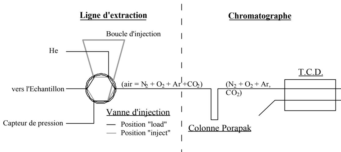
*Figure II-1 : Configuration initiale de la ligne d'analyse.*
