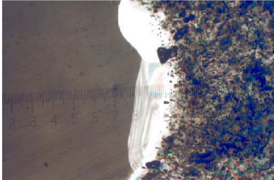
Fig. 5.16 : Recristallisation statique à la frontière inclusion (à gauche) - matrice, échantillon A45-1.
