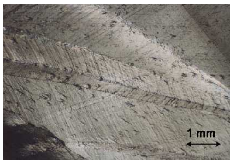
Fig. 5.15 : Zone fortement localisée, polygonisation sous forme de grains lamellaires, échantillon C-2 déformé à 6.7%.
