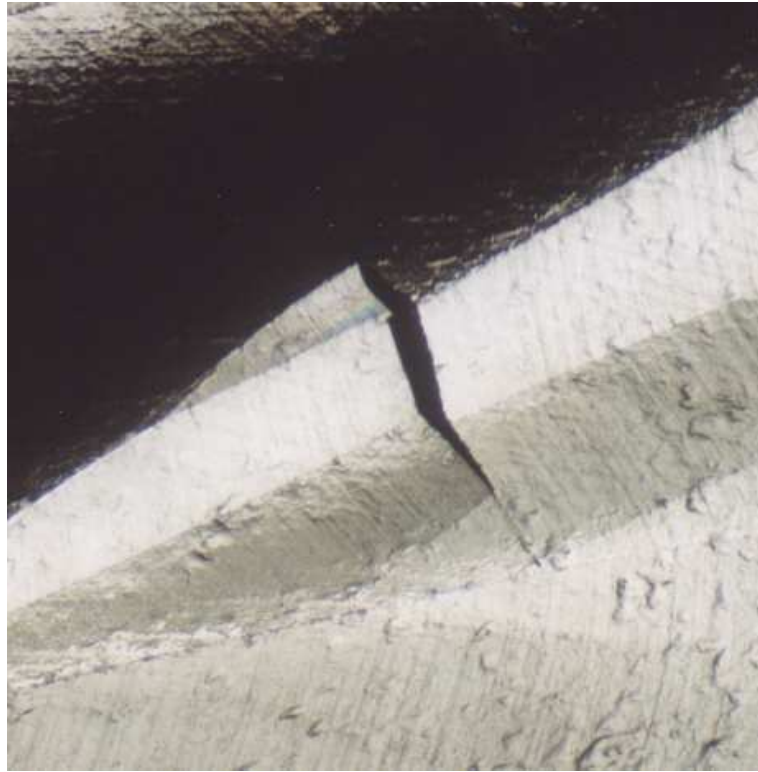
Fig. 5.13: Fissure de clivage, échantillon C-2.
