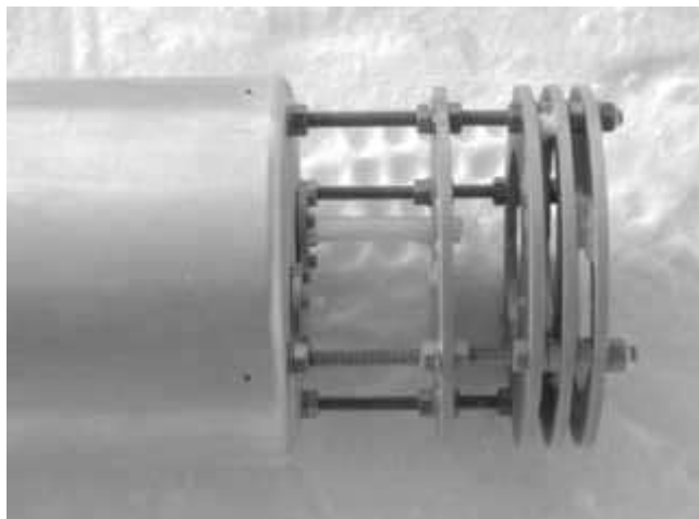
Figure IV.3 : Extrémité profonde du manchon, où l'on distingue les 2 tubes de prélèvement de l'air : le plus court, au ras de l'extrémité, permettant de purger le fond du trou de forage, et le plus long pour le prélèvement des échantillons.
