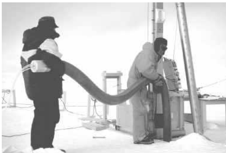
Figure IV.1 : Introduction du manchon gonflable dans le trou de forage à Dome C (Antarctique)
