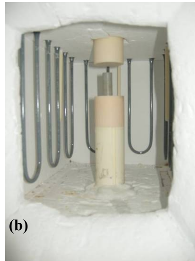
Figure 2- 3. Dispositifs de compression : (a) à l'ambiante ; (b) en température.
