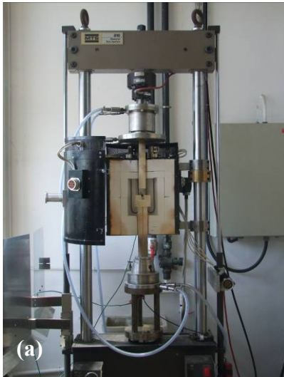
Figure 2- 38. (a) Machine d'essai hydraulique Instron utilisée. (b) Positionnement de l'échantillon dans l'enceinte du four.
