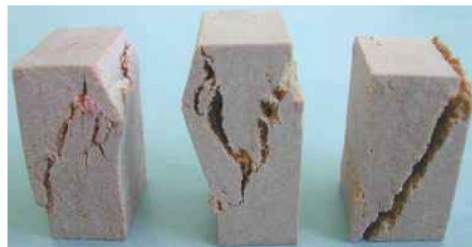
Figure 1- 7. Eprouvettes de THTZ après essais de compressions respectivement à 1000°C, 1200°C et 1400°C [LAT 05].
