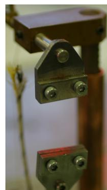
**Figure IV.13** : Mors usinés au laboratoire pour réaliser des essais de traction sur les films fins.
