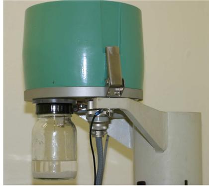
**Figure III.14** : Thermobalance modifiée : précision 0.1mg, capacité 100mg.
