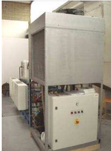
Figure III.1 : Photographie du prototype de thermofrigopompe
