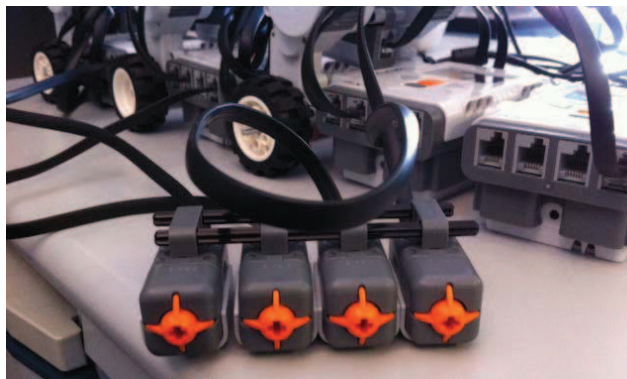
Figure 4- 11. Quatre capteurs tactile reliés respectivement à chaque NXT Micro-Processeur
