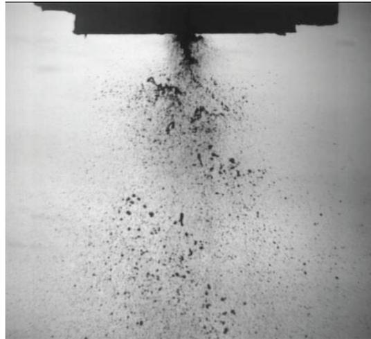
**Figure I.27** : Image d'un jet d'atomisation par ombroscopie [Guézennec 10]
