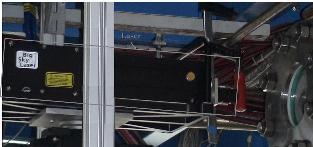
**Figure II.5** : Photo du laser double cavité de la gamme « Twins Big Sky Laser ».
