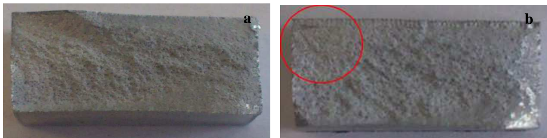
Figure 3.48. Faciès de rupture d'éprouvettes testées à une contrainte maximale de 36 kN et R = 0,1 (a) vue d'ensemble typique de surface rompue sans zone de rupture claire, (b) vue d'ensemble d'une zone de rupture claire par fatigue
